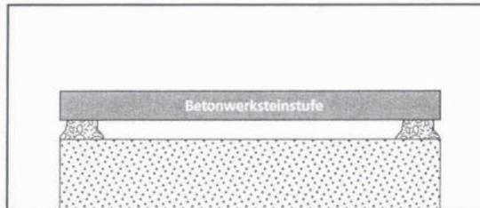
Bei Längen über 1,10 m sind die Mörtelstreifen nach innen zu verlegen (auf  $\frac{1}{6}$  der Gesamtlänge, nicht breiter als 12 cm)
